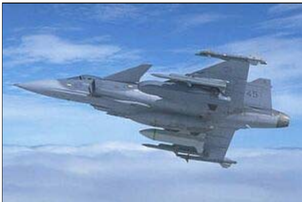
Gripen mit DWS 39 unter der rechten und TAURUS unter der linken Tragfläche.
